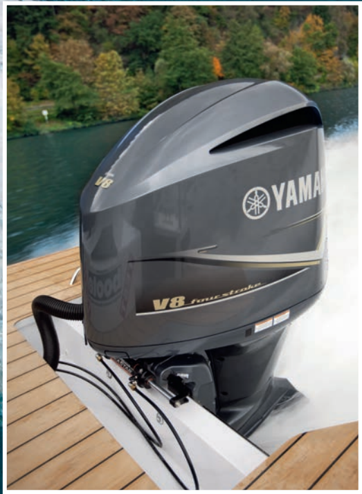
Mercury Verado 350 (o.) gegen Yamaha F350: Der Amerikaner besitzt sechs Zylinder und einen Kompressor, beim Asiaten setzt man auf V8 und ordentlich Hubraum
