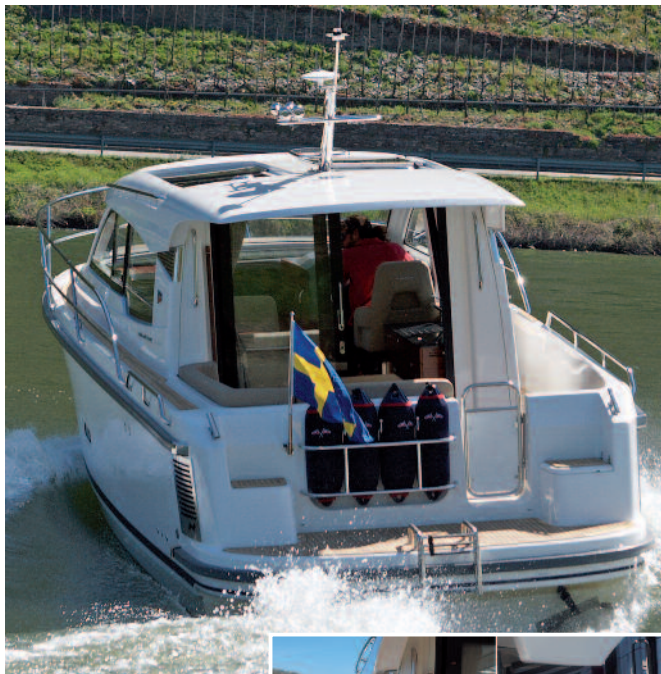
Sidewalk: Das Konzept ergibt ein breites Gangbord an Steuerbord und ermöglicht den bequemen Zugang aufs Vorschiff. An Backbord bleibt genug Platz.
