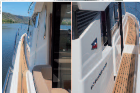
Sidewalk: Das Konzept ergibt ein breites Gangbord an Steuerbord und ermöglicht den bequemen Zugang aufs Vorschiff. An Backbord bleibt genug Platz.
